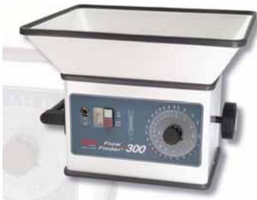
Abbildung 49: Volumenstrommessgerät mit Nulldruckkompensation (FLOWFINDER, Fa. ACIN)
